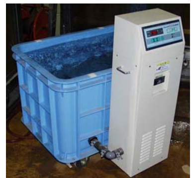
写真3 水稻種子の温湯処理機
