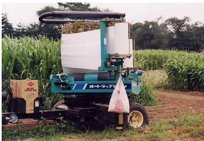
写真5 「葉月」のラッピング作業
