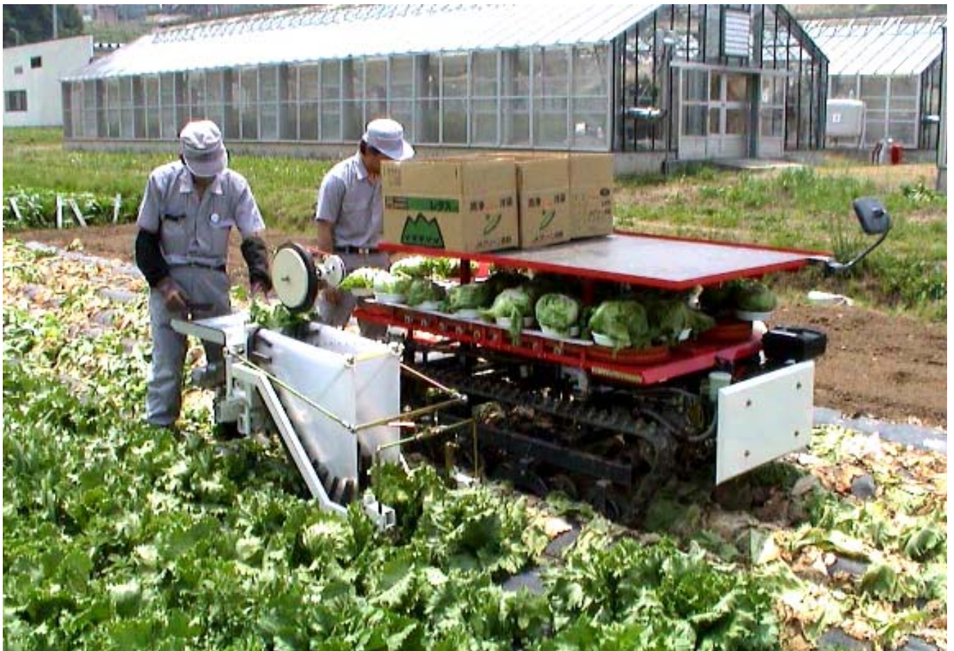
「長野式レタス収穫機」による作業風景(農業総合試験場機械施設部圃場にて)
